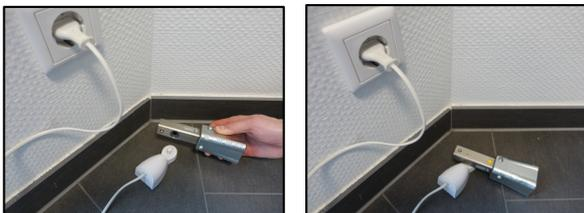
Stecken Sie zunächst die Induktiv-Ladestation in eine dafür vorhergesehene 230V~-Steckdose. Um den Ladevorgang zu starten, legen Sie nun die Betätigungsnuß auf die entsprechende Schnittstelle.
