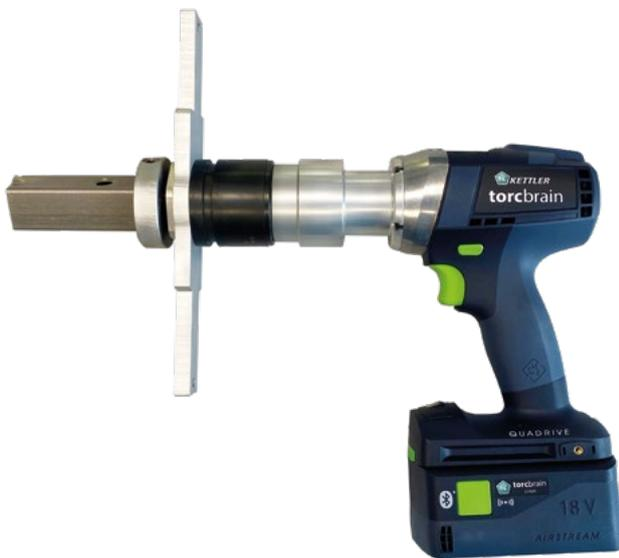
Das wälzgelagerte Präzisionsgetriebe wurde unter Verwendung hochwertiger Werkstoffe speziell für den Anwendungsfall entwickelt und zeichnet sich durch geringen Verschleiß und einen hohen Wirkungsgrad aus. Die Ausführung als 4-Gang-Planetengetriebe ermöglicht die Abdeckung eines sehr großen Drehmomentbereichs bei gleichzeitig geringem Gewicht und kompakter Bauform.
