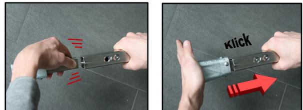
Zum Einsetzen drücken Sie beide Rastnasen an der Betätigungs-nuss zusammen und führen diese am unteren Ende des Außenrohres so ein, dass die Rastnasen parallel zu den vorgebohrten Löchern verlaufen. Schieben Sie nun die Betätigungs-nuss so weit in das Außenrohr, bis die Rastnasen in die dafür vorgesehenen Löcher hörbar einrasten.
