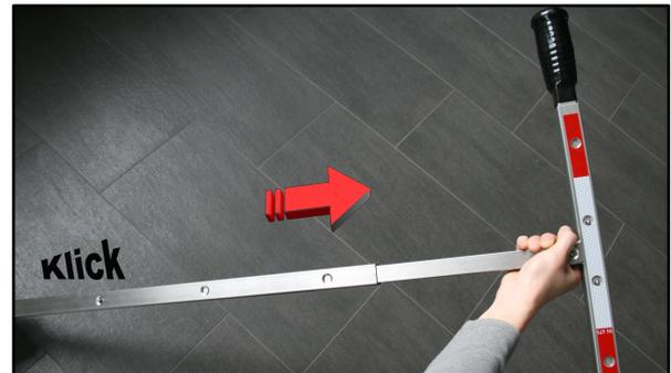
Schieben Sie den Quergriff so lange, bis die Rastnasen des Innenrohres wieder in die vorgebohrten Löcher des Außenrohres hörbar einrasten. Wiederholen Sie diesen Vorgang so lange, bis die gewünschte Länge erreicht ist. Beim Zusammenschieben verfahren Sie in umgekehrter Reihenfolge.
