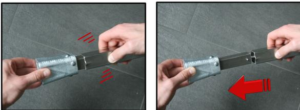
Zum Lösen der Betätigungs-nuss drücken Sie die beiden Rastnasen des unteren Druckstücks zusammen und ziehen Sie gleichzeitig mit der anderen Hand die Betätigungs-nuss aus dem Außenrohr.
