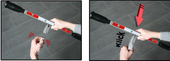
Drücken Sie beide Rastnasen des Druckstücks am oberen Ende des Verlängerungsgestänges zusammen und führen es in das untere Ende des Quergriffes so ein, dass die Rastnasen parallel zu den Löchern im Quergriff verlaufen. Schieben Sie nun den Quergriff so weit auf das Verlängerungsgestänge, bis die Rastnasen in die dafür vorgesehenen Löcher des Quergriffes hörbar einrasten.
