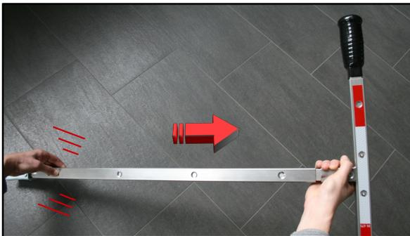
Drücken Sie beide Rastnasen des oberen Druckstücks des unteren Verlängerungsgestänges zusammen und schieben Sie gleichzeitig den Betätigungsschlüssel am Quergriff nach oben.
